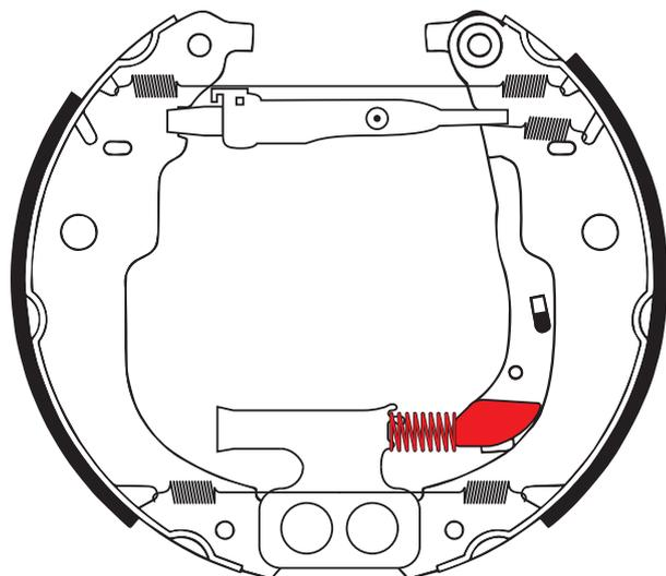
Bei o. g. Fahrzeugen befinden sich zur industriellen Vormontage werksseitig jeweils ein Halteblech und eine Feder (rot gekennzeichnet) im Bereich des Bremsbackenhebels.
